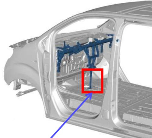
2/ Abstützung: unter der Mittelkonsole; diese Stütze muss zum Wegklappen des Frontmoduls durchtrennt werden.
